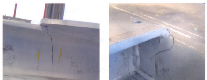
Abb. 8: Verzinkungsrisse am Fahrzeugrahmen aus hochfestem TM-Stahl S 690 M ( t = 6\text{mm} )
